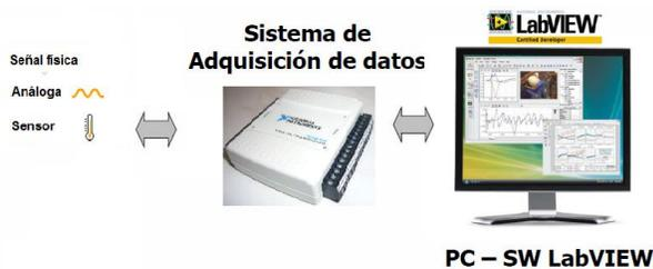
2. Interfaz gráfica de usuario, bajo plataforma LabView, registro y linealización del transmisor de temperatura y conversión a grados Celsius, rango de calibración 0-400 grados.
